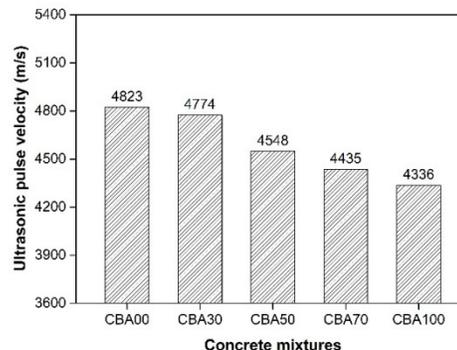
Fig. 4. UPV values of concretes.
